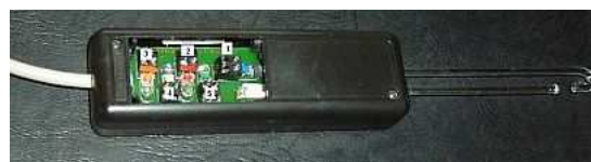
Abb. 7: Eingesetzter Tauchvorsatz (im Bild sind die 5 LED-Lampen erkennbar) [2]
